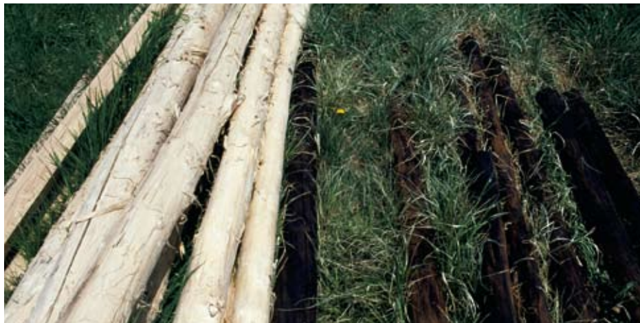
Contrairement au bois traité à la créosote (droite), les poteaux de robinier (gauche) ne causent aucune brûlure aux plantes (remarquez la croissance de l'herbe entre les poteaux).
